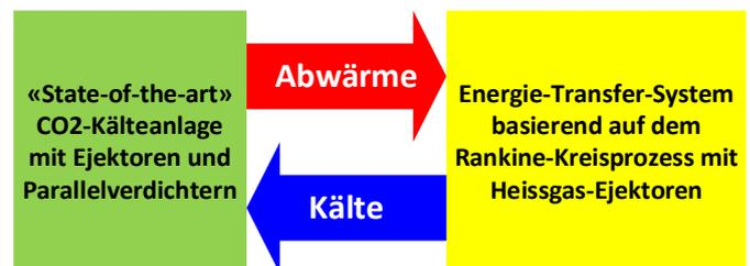
Abbildung 2: Schnittstellen zwischen der CO<sub>2</sub>-Kälteanlage und dem innovativen Energie-Transfer-System.
